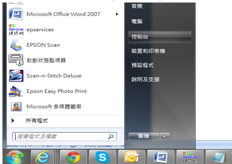
步驟 2、進入「控制台」→「硬體和音效」→「裝置和印表機」，滑鼠游標對著「EPSON AL-MX14NF」按右鍵，點選「列印喜好設定」。
